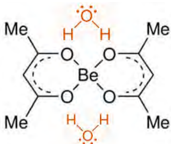
Rys. 1. Schemat hydratacji zewnątrz-sferowej kompleksu acetyloacetonianu berylu
