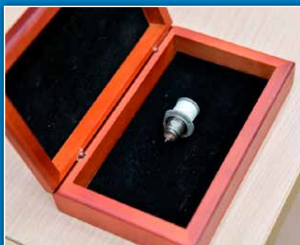
Lampa do fluorescencji rentgenowskiej zaprojektowana dla NASA i zamontowana na ramieniu łazika marsjańskiego
