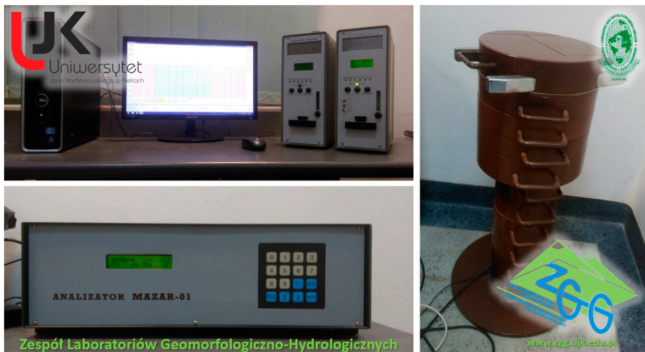
Fot. 3. Wyposażenie Zespołu Laboratoriów Geomorfologiczno-Hydrologicznych w Instytucie Geografii i Nauk o Środowisku Uniwersytetu Jana Kochanowskiego w Kielcach. Czytelniki TL oraz OSL „Laboratory Reader-Analyser RA’04” (góra), mierniki stężenia pierwiastków promieniotwórczych „MAZAR-01” (dół) oraz kolumna pomiarowa (z prawej; fot. P. Przepióra)
