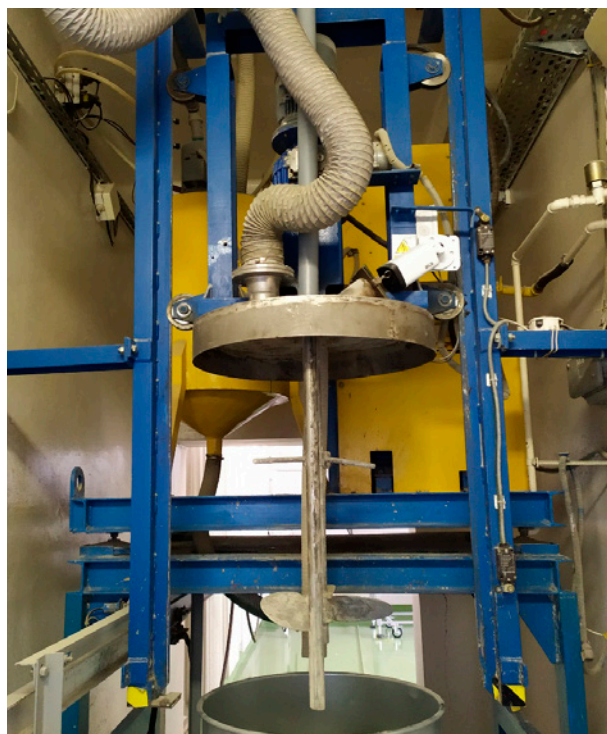
Fot. 7. Mieszadło wraz z zintegrowanym systemem dozowania cementu oraz zatężonych ciekłych odpadów Photo 7. Agitator with integrated cement and concentrated liquid waste dosing system
