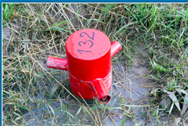
Piezometr nr 132 służący do pobierania próbek wody
