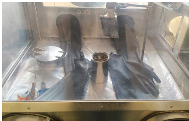
Fot. 10. Wnętrze komory rękawicowej do demontażu izotopowych czujek dymu. Na środku widoczna jest stalowa pushka ze zdemontowanymi źródłami
