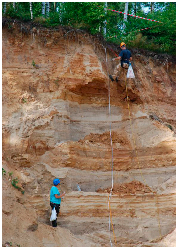
Fot. 4. Pobieranie próbek z osadów budujących wzgórze kemowe z okresu zlodowaceń środkowopolskich (północne obrzeżenie Gór Świętokrzyskich; fot. T. Kalicki)
