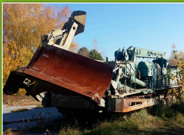
Inżynierski pojazd wojskowy do wykonywania pasów przeciwpożarowych.
