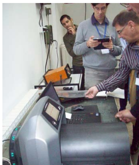
Fot. 3. Skaner do odczytu i rejestracji obrazów (fot. Wojciech Głuszewski) Photo. 3. Scanner for reading and recording images (photo: Wojciech Głuszewski)
