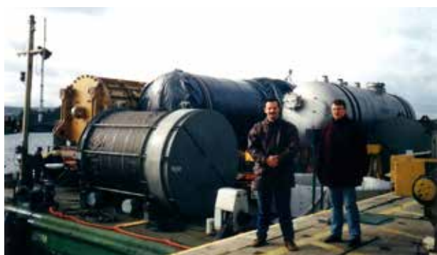
Fot. 5. Zbiornik, blok górny i urządzenia wewnętrzno-zbiornikowe reaktora oraz wytwornica pary załadowane na ponton w Porcie Gdynińskim z przeznaczeniem dla EJ Loviisa w Finlandii (fot. Port Consultants)
