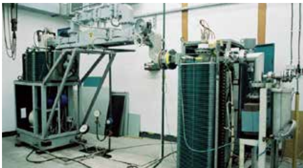
Fot. 2. Elementy akceleratora Elektronika 10/10 wykorzystywanego do sterylizacji wyrobów medycznych
