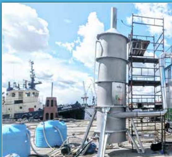
Skruber zaprojektowany w Instytucie Chemii i Techniki Jądrowej, a wykonany przez lubelską firmę Biopolinex
