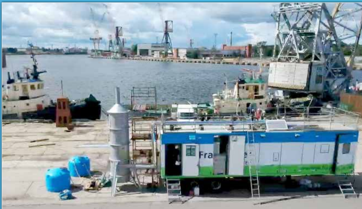
Nabrże stoczni z holownikiem, mobilnym akceleratorem zainstalowanym na przyczepie i skruberem
