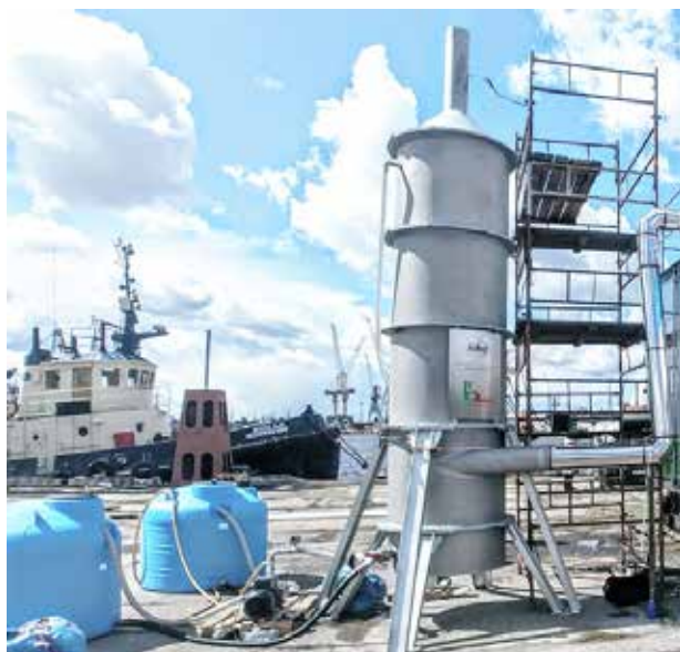
Fot. 1. Skruber zaprojektowany w Instytucie Chemii i Techniki Jądrowej, a wykonany przez lubelską firmę Biopolinex (fot. https://biopolinex.pl/od-badan-laboratoryjnych-do-zastosowania-w-przemysle )
