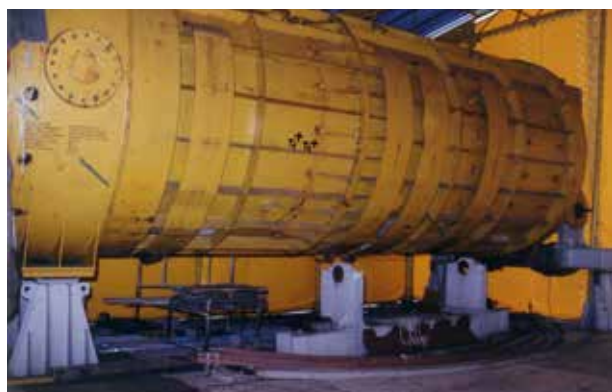
Fot. 3. Blok górny reaktora 1- bloku magazynowany w tymczasowym namiocie na placu budowy EJ „Żarnowiec” (fot. W. Kielbasa)
