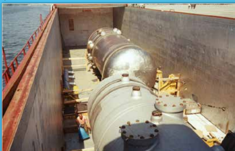
Transport morski zbiornika reaktora i wytwornicy pary do Ośrodka Szkoleniowej EJ Paks (Węgry)
