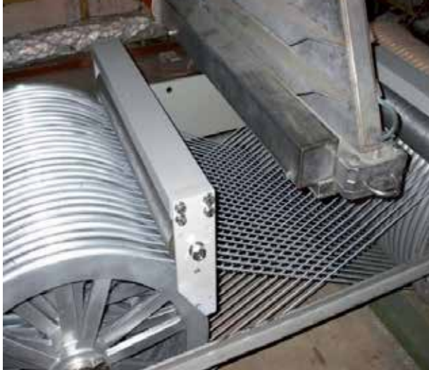
Fot. 1. Sieciovanie izolacji przewodów na akceleratorze ILU-6
