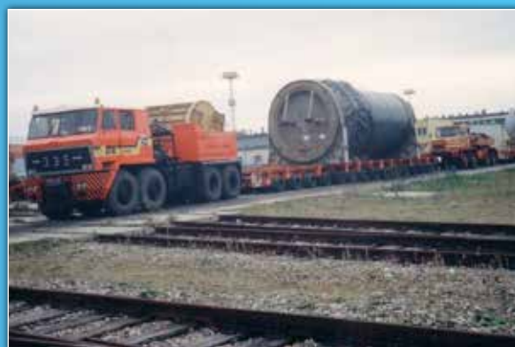
Transport zbiornika i bloku górnego reaktora oraz wytwornicy pary do Portu w Gdyni z przeznaczeniem dla EJ Loviisa (Finlandia)
