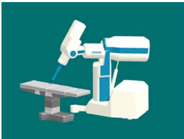
Fot. 2. Akcelerator IntraLine-IOERT przy stole operacyjnym – symulacja komputerowa
