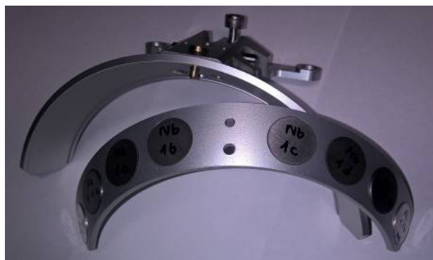
Fot. 8. Uchwyt pozwalający przymocować do generatora w sposób powtarzalny próbki aktywacyjne. W części centralnej dwie folie niobowe oznaczone 1b i 1c
