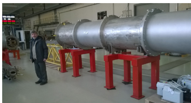
Fot. 7. Wstępne łączenie elementów kriostatu systemu NICA w hali montażowej (z archiwum ZIBJ)
