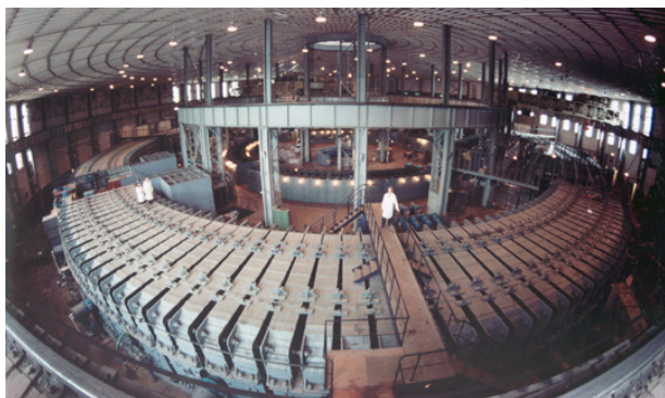
Fot. 3. Synchrofazotron zbudowany pod kierownictwem W. Wekslera w 1957 r., największy w tym czasie przyspieszacz cząstek, przyspieszał protony do energii 10 GeV. Obecnie zdemontowany
