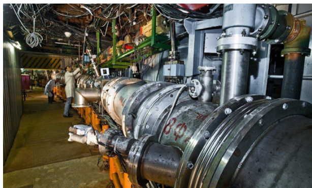
Fot. 1. Nuklotron pierwszy w świecie nadprzewodzący przyspieszacz cząstek zbudowany w 1993 r. pod kierownictwem A. Baldina będzie jednym z podstawowych urządzeń budowanego Kompleksu NICA (fot. z archiwum ZIBJ, DUBNA)
