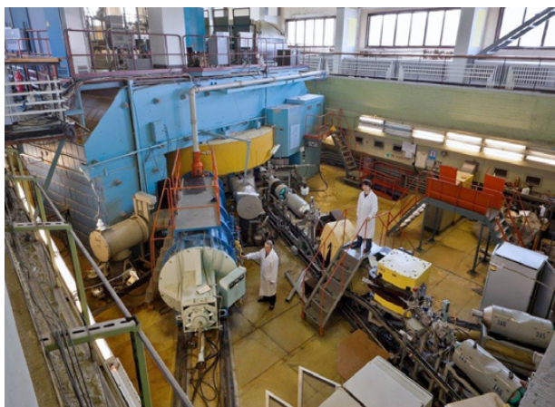
Fot. 4. Cyklotron U-400 zbudowany pod kierownictwem G. Flerowa i J. Oganjesjana w 1979 r. jest urządzeniem, na bazie którego otrzymuje się kolejne superciężkie pierwiastki
