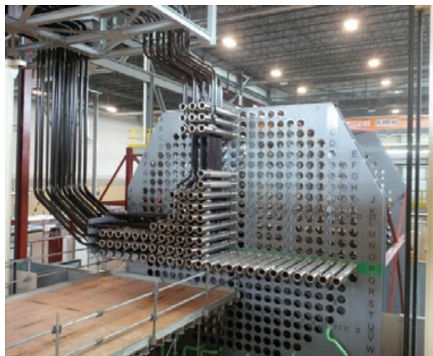
Fot. 6. Makieta D-2; Płaszczyzna graniczna reaktora, końcówki kanałów i rury odpływu/dopływu
