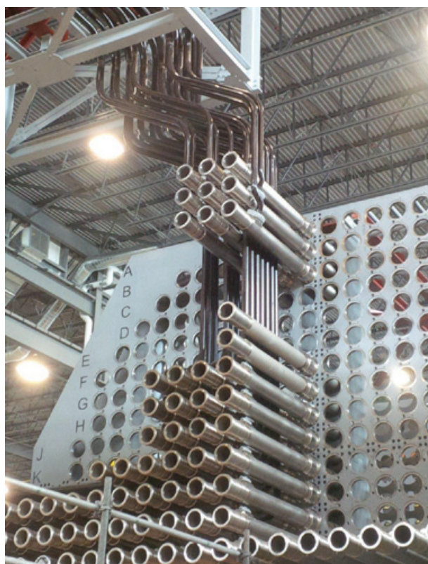
Fot. 2. Makieta Reaktora 2 w elektrowni Darlington (D-2); końcówki kanałów i rury odpływu/dopływu
