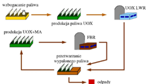
Rys 3. Schemat funkcjonowania przemysłu jądrowego w przypadku koegzystencji elektrowni III i IV generacji. Odpady stanowią jedynie produkty rozpadu, które osiągają poziom promieniowania naturalnych złóż uranu po ok. 300 latach
