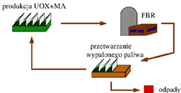
Rys 2. Schemat funkcjonowania przemysłu jądrowego z uruchomionymi elektrowniami IV generacji bez współistnienia elektrowni II i III generacji. Odpady stanowią jedynie produkty rozpadu, które osiągają poziom promieniowania naturalnych złóż uranu po ok. 300 latach
