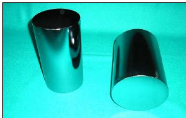
Fot. 1. Monokryształy krzemu przygotowane do procesu neutronowego domieszkowania (NTD – Neutron Transmutation Doping); średnica: 5 i 6 cali / wysokość 250 mm / ładunek w kanale do napromieniania: 500 mm
