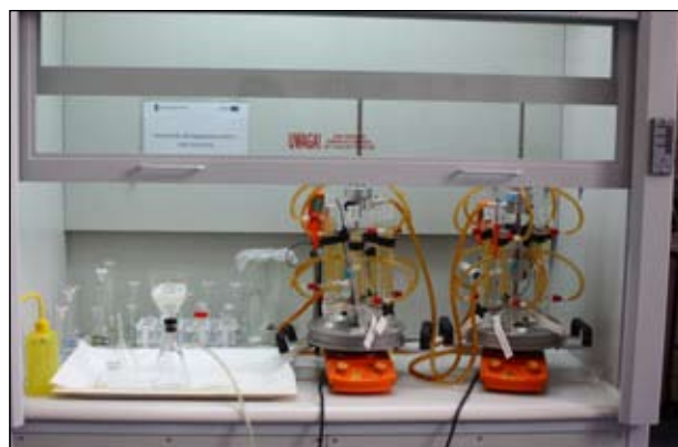
Fot. 2. Stanowisko do ługowania rudy uranowej
