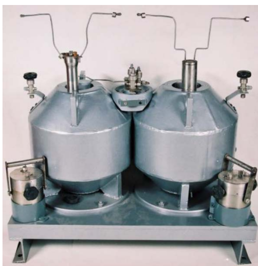
Rys. 4.18. Przemysłowy generator wytwarzania bromku metylu \text{CH}_3\text{Br} znakowanego radioizotopem \text{Br-82}
