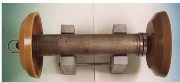
Rys. 4.20. Detektor w osłonie przemieszczającej się w rurociągu
