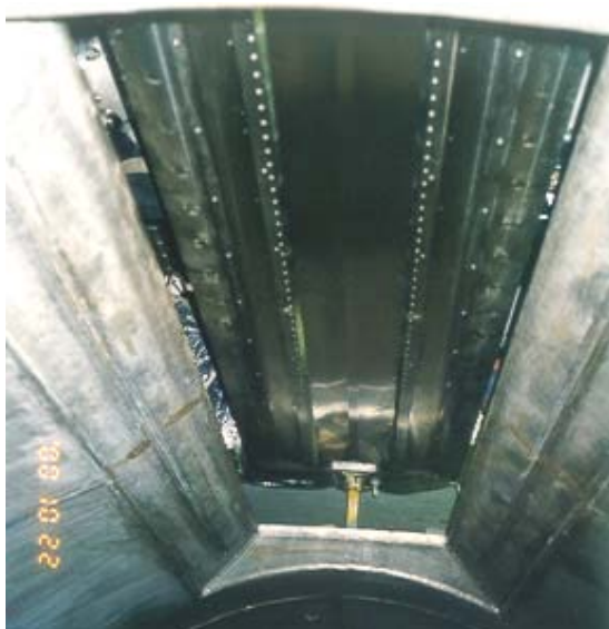
Rys. 9.14. Widok okna wyjściowego akceleratora z folii tytanowej
