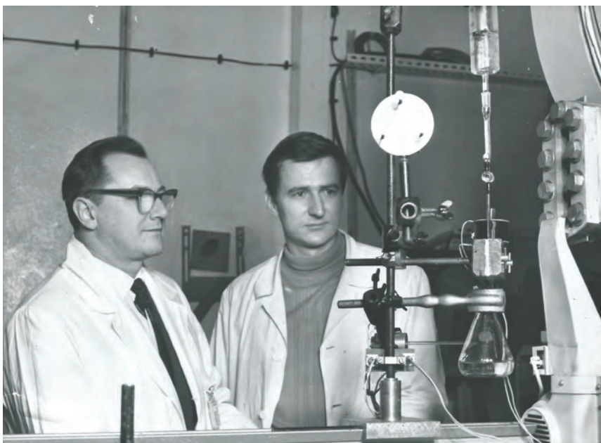
Fot.4. Stanowisko eksperymentalne wykorzystujące do celów analitycznych promieniowanie Czerenkowa. Od lewej: prof. Z.P. Zagorski, dr Z. Zimek.
