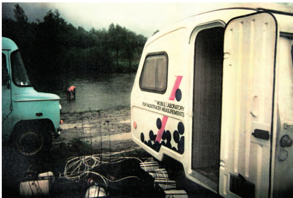
Fot.1. Ruchome laboratorium pomiarowe do badań radioizotopowych – badania ruchu rumowiska rzecznego (lata 1980-1990).
