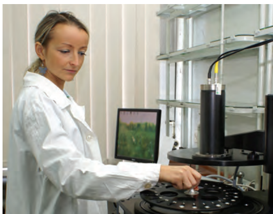
Fot.4. Mgr inż. Magdalena Sadowska identyfikuje napromieniowanie artykułów spożywczych metodą termoluminescencji za pomocą czytnika RISØ TL/OSL-DA-20 (2012 r.).
