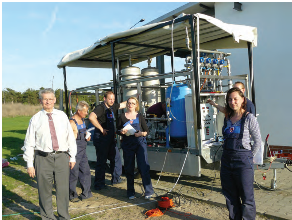
Fot.5. Mobilna instalacja membranowa do zateżzania biogazu w metan – miejska oczyszczalnia ścieków w Puławach (prof. A.G. Chmielewski z ekipą pomiarową).
