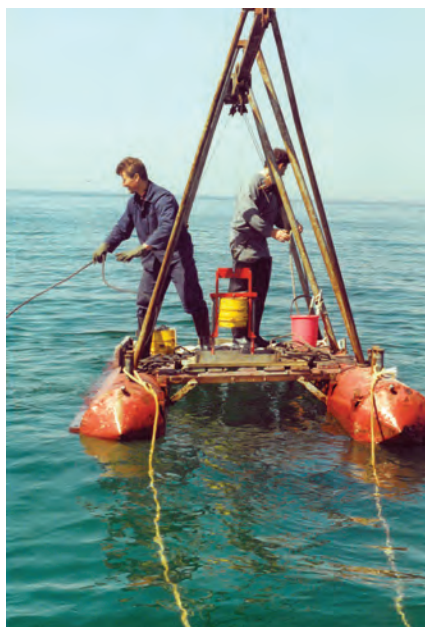
Fot.2. Badania radioizotopowe transportu rumowiska w przybrzeżnej strefie Bałtyku w Lubiawie (Ryszard Wierchnicki i Henryk Burliński).
