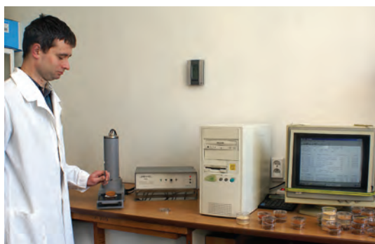
Fot.5. Mgr inż. Grzegorz Guzik bada napromieniowane przypraw roślinnych metodą luminescencji stymulowanej impulsami światła na urządzeniu SURRC Irradiated Food Screening System (2012 r.).
