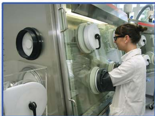
Boks rękawicowy do pracy z otwartymi źródłami promieniotwórczości o wysokiej aktywności
