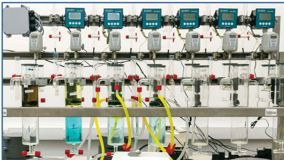
Zestaw mixer–settler do badania ekstrakcji rozpuszczalnikowej do odzysku metali po ługowaniu
