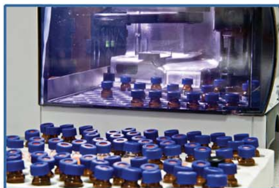
Przygotowanie wzorców radiochemicznych do badań w ramach monitoringu radiacyjnego
