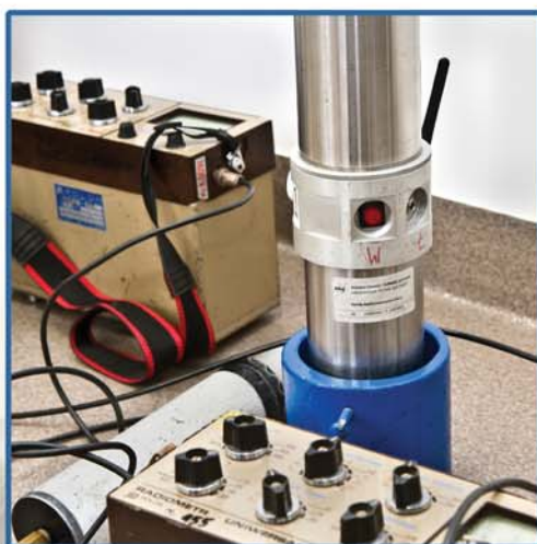
Detektor do badania szczelności obiektów technologicznych
