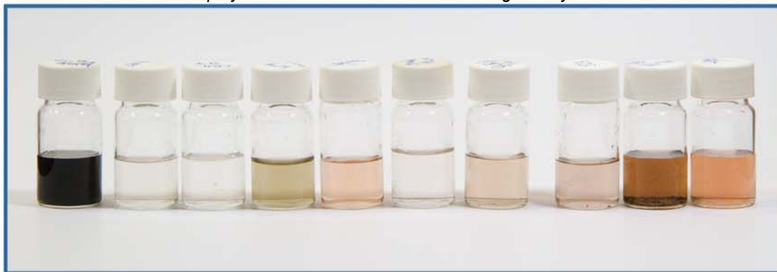
Porównanie skuteczności usuwania rutenu z roztworów wodnych przy zastosowaniu sorbentów metaloorganicznych
