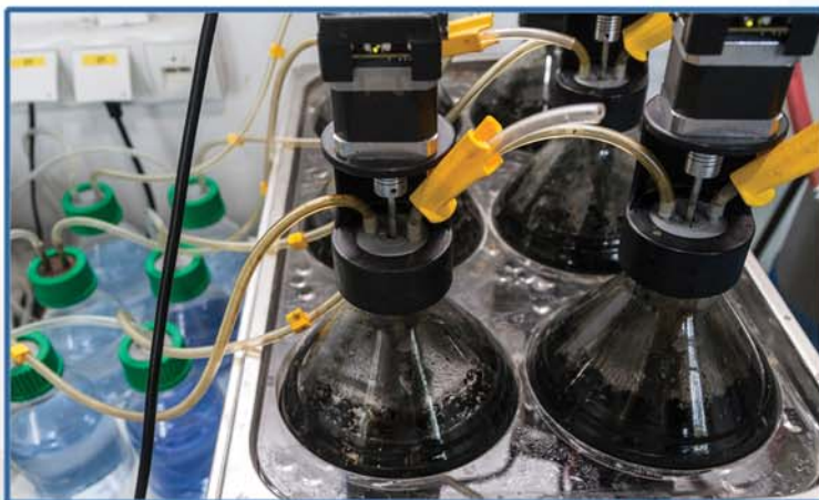
Układ AMPTS II – zestaw bioreaktorów do prowadzenia procesu fermentacji w celu pozyskania biogazu
