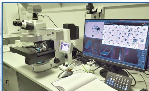
Mikroskop Zeiss z systemem Metasystems do analizy zmian wywołanych przez czynniki genotoksyczne w materiale genetycznym komórek
