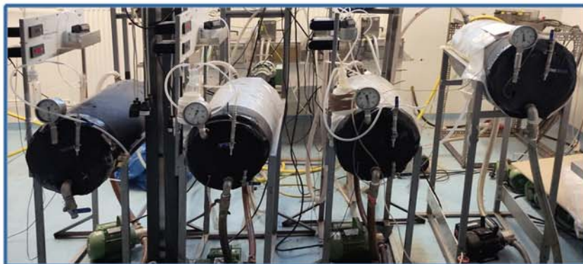
Zestaw bioreaktorów do prowadzenia procesu fermentacji w celu pozyskania biogazu
