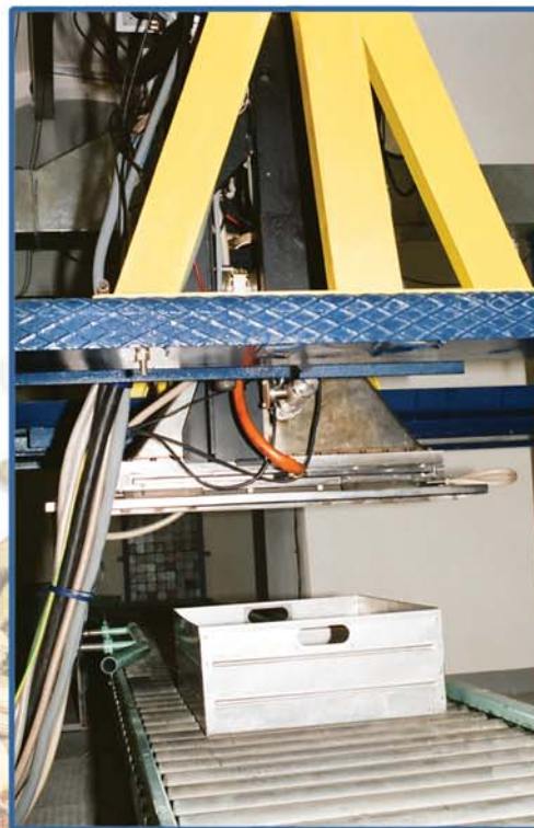
Akcelerator elektronów wykorzystywany do napromieniowywania żywności
