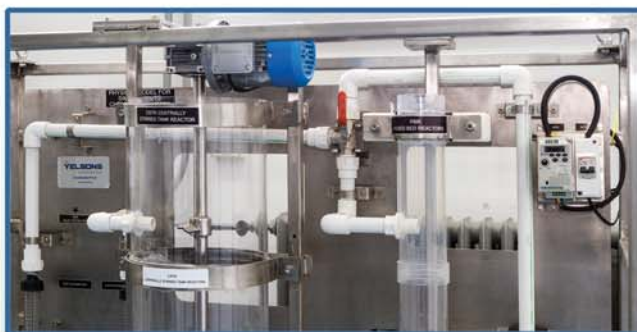
Flow-rig – reaktor chemiczny do pomiarów RTD
