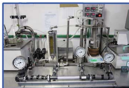
Instalacja do destylacji membranowej wykorzystywana do przetwarzania ciekłych odpadów promieniotwórczych o dużym zasoleniu
