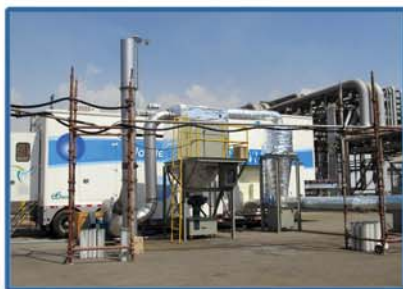
Instalacja laboratoryjna do badań nad hybrydową metodą oczyszczania spalin
