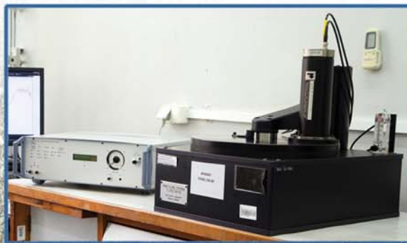
Czytnik termoluminescencji RISØ TL/OSL System, model TL-DA-20
