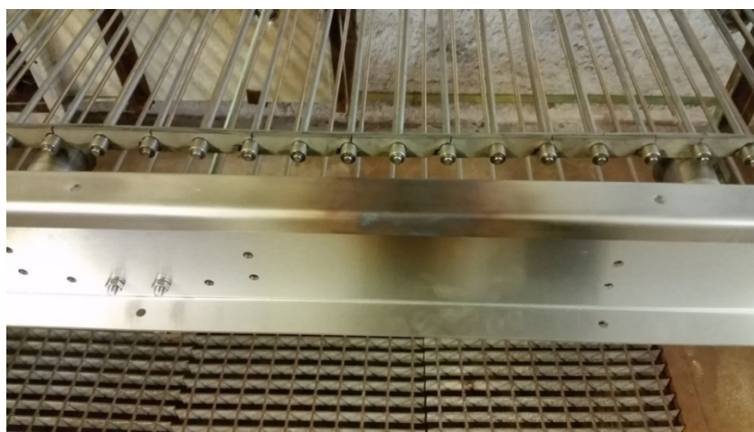
Rys. 14. Charakterystyczne brązowe przebarwienie widoczne na powierzchni wsporcze go ceownika konstrukcji nośnej transportera.
