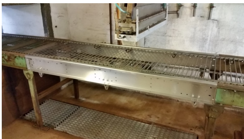
Rys. 12. Widok transportera zainstalowanego pod wylotem wiązki elektronów (A) oraz fragmentu transportera z widoczną strukturą wsporczą (ceowniki korpusu i rolki prowadzące), prętami nośnymi spiętymi ogniwami o kształcie pozwalającym na wzajemne blokowanie w pozycji poziomej i tulejkami współpracującymi z kołami zębatymi.
