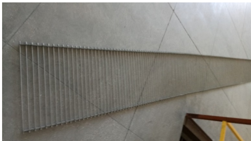
Rys. 11. Struktura nośna transportera z prętów ze stali nierdzewnej.
