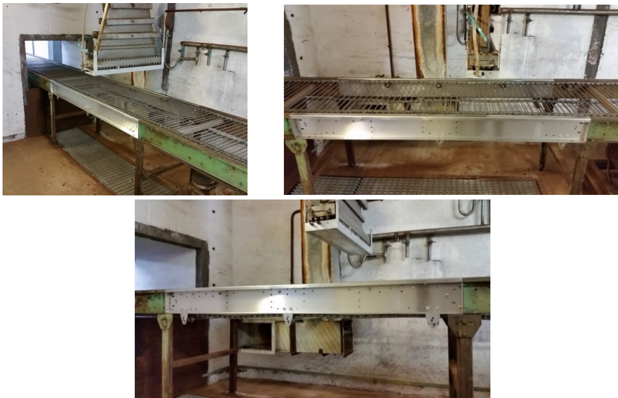
Rys. 13. Widok elementów mechanicznych transportera po rekonstrukcji.
