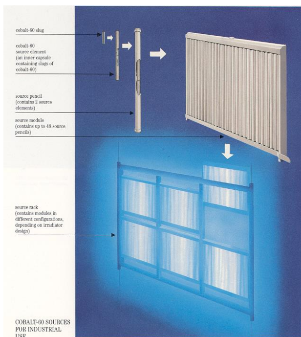
RYS. 3. Schemat przedstawiający prostokątną szkieletową ramę zbiorczą, w której mocowane są pojedyncze rurki zawierające pastylki wykonane z kobaltu (zdjęcie otrzymano z MDS Nordion, Kanada)
