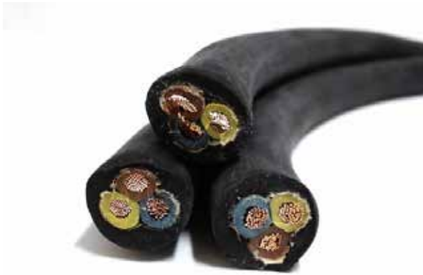
Fot. 1. Kabel średnionapięciowy. Osłona wykonana z gumy etylenowo-propylenowej (EPR) wypełnionej w 60% wodorotlenkiem glinu ( Al(OH)_3 ) pełniącym funkcję opóźniacza palenia [18]
