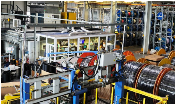
Fot. 4. Widok hali technologicznej i sterowni akceleratora ILU-10 w firmie Radpol z Człuchowa produkującej w skali masowej rury i mufy termokurczliwe modyfikowane radiacyjnie
