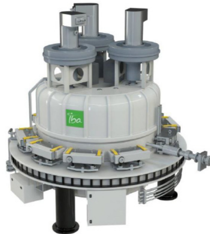
Fot. 5. Widok ogólny akceleratora typu Rhodotron. W części górnej zamontowane są elementy układu generacyjnego, po obwodzie rezonatora są zainstalowane elektromagnesy odchylające wiązkę elektronów
