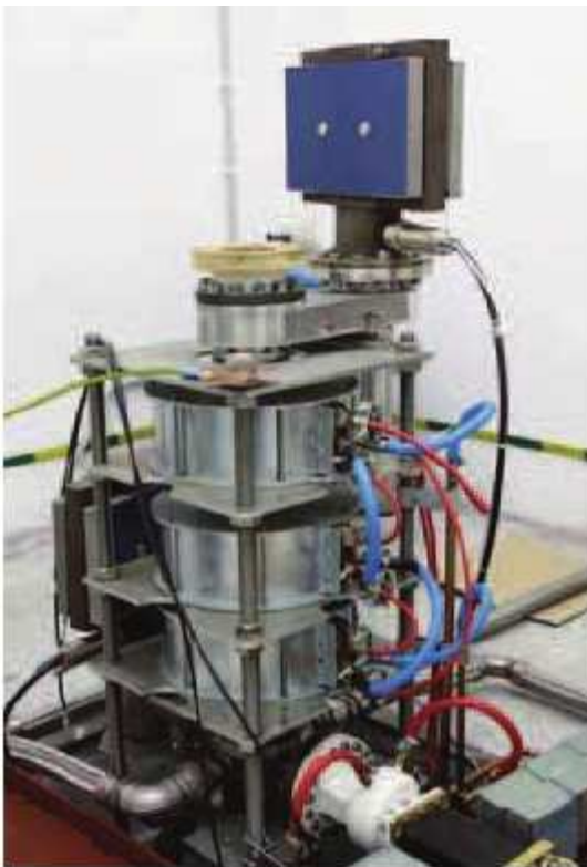
Sekcja przyspieszająca budowana w IChTJ akceleratora elektronów LAE 10/15 (10 MeV, 15 kW) z instalacją wyrzutnią elektronów, jonową pompą próżniową oraz zespołem cewek ogniskujących wiązkę elektronów
