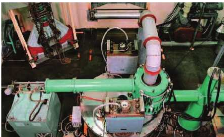
Akcelerator elektronów ILU-6 wykorzystywany do modyfikacji polimerów oraz badań nad oczyszczaniem gazów spalinowych z NO x , SO 2 i VOC
