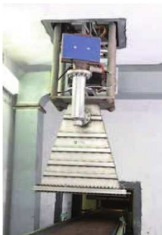
Skaner wiązki elektronów akceleratora zamontowanego w stacji sterylizacji radiacyjnej sprzętu medycznego
