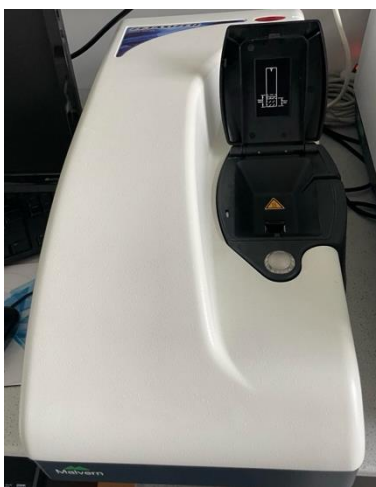
Fot. 1. Urządzenie Zeta Sizer Nano ZS stosowane do pomiarów DLA oraz potencjału zeta.
