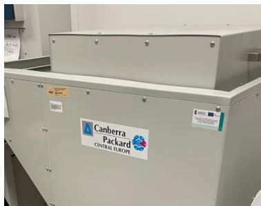
Fot. 5. Detektor germanowy wysokiej czystości zastosowany do pomiaru aktywności promieniotwórczej próbek w analizie stabilności oraz frakcjonowania jądra komórkowego.
